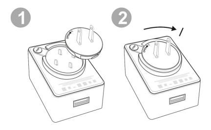
2. Pour démonter le chargeur, pressez le bouton PUSH, tournez la prise dans le
